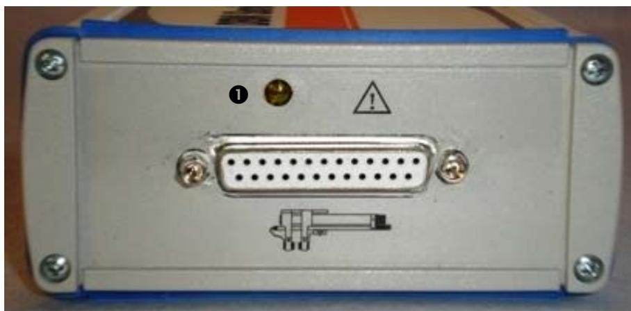
Figura 13 – Pannello frontale e Spia di segnalazione di emissione del segnale US
