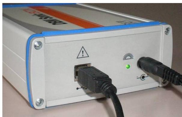
Figura 6 – Pannello posteriore unità di misura
